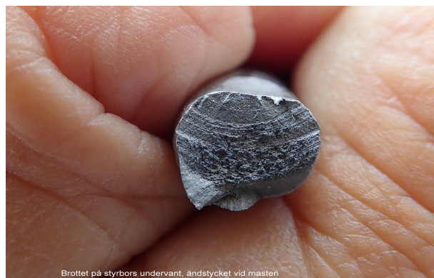
6 Brottytan. Restbrottet syns tydligt i nedre delen och skedde då det bara var 15-20% kvar av tvärsnittet
